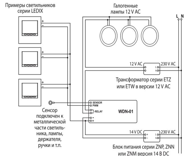
Управление в секвенции **вкл./ выкл.:** очередные короткие прикосновения к проводящей части, подключенной к датчику.
