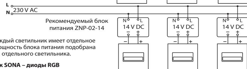
Схема 2. Каждый светильник имеет отдельное питание. Мощность блока питания подобрана к мощности отдельного светильника.
