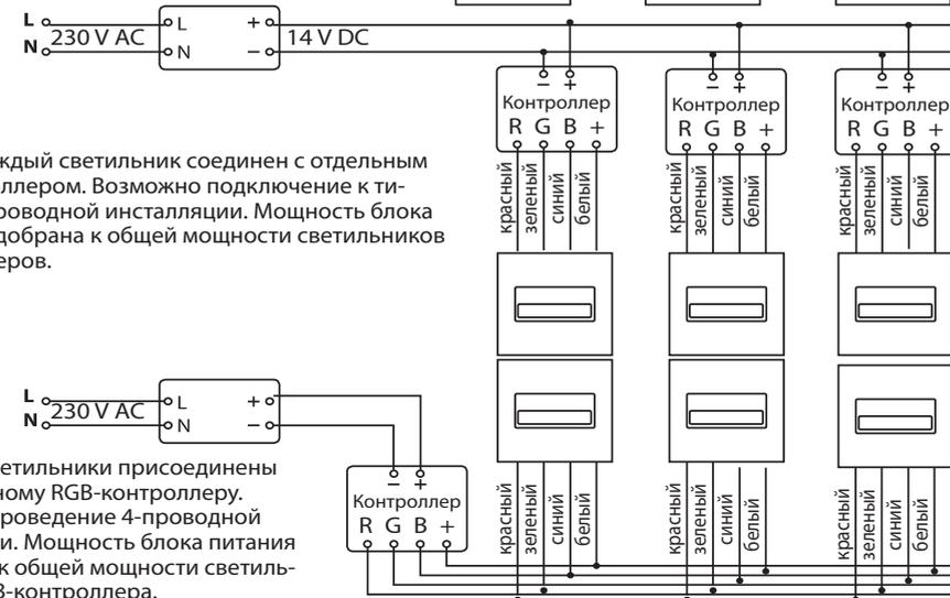
Схема 3. Каждый светильник соединен с отдельным RGB-контроллером. Возможно подключение к типичной 2-проводной инсталляции. Мощность блока питания подобрана к общей мощности светильников и контроллеров.
