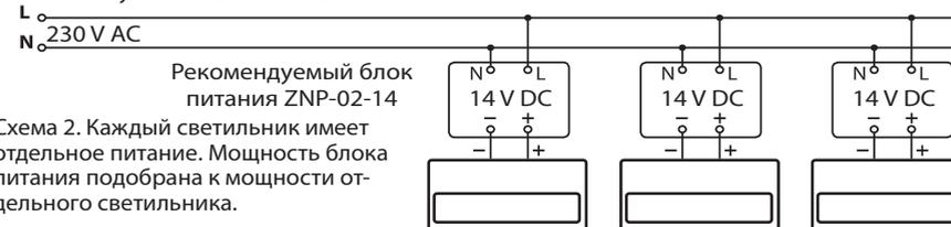
Схема 2. Каждый светильник имеет отдельное питание. Мощность блока питания подобрана к мощности отдельного светильника.
