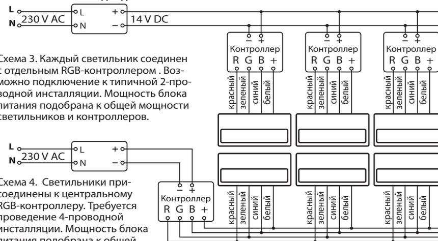
Схема 3. Каждый светильник соединен с отдельным RGB-контроллером. Возможно подключение к типичной 2-проводной инсталляции. Мощность блока питания подобрана к общей мощности светильников и контроллеров.
