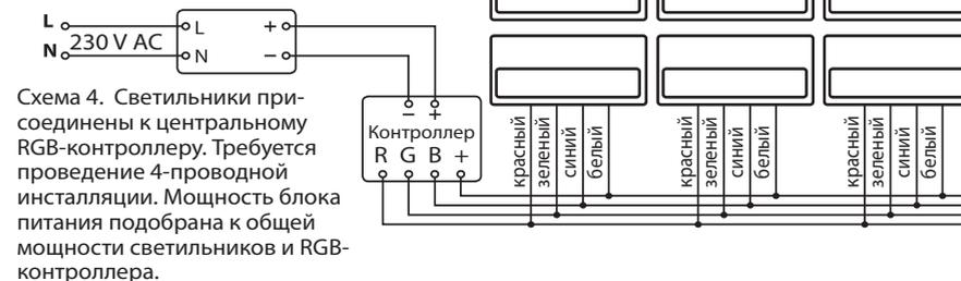
Схема 4. Светильники присоединены к центральному RGB-контроллеру. Требуется проведение 4-проводной инсталляции. Мощность блока питания подобрана к общей мощности светильников и RGB-контроллера.
