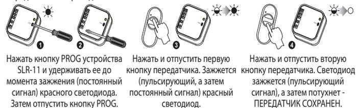
Пример процедуры программирования с использованием пульта управления P-257/2. Для остальных радиопередатчиков EXTA FREE процедура аналогична.
