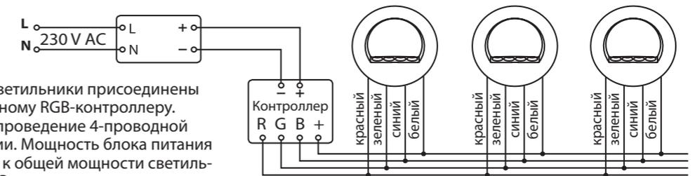
Схема 4. Светильники присоединены к центральному RGB-контроллеру. Требуется проведение 4-проводной инсталляции. Мощность блока питания подобрана к общей мощности светильников и RGB-контроллера.
