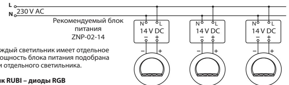
Схема 2. Каждый светильник имеет отдельное питание. Мощность блока питания подобрана к мощности отдельного светильника.
