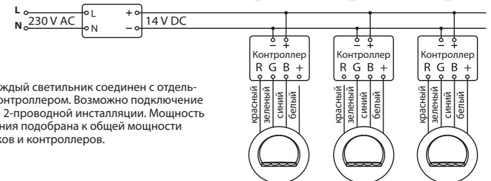
Схема 3. Каждый светильник соединен с отдельным RGB-контроллером. Возможно подключение к типичной 2-проводной инсталляции. Мощность блока питания подобрана к общей мощности светильников и контроллеров.
