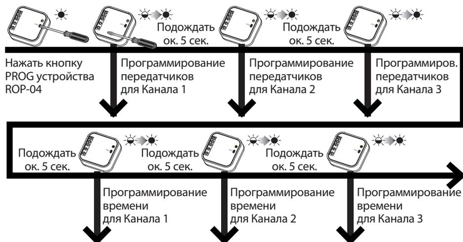
Для облегчения программирования радиопередатчиков, каждый раз при входе в режим программирования данного канала (или установки времени во временном режиме), включается нагрузка, подключенная к данному каналу. Включение канала сопровождается свечением (постоянный сигнал) красного светодиода STATUS.
