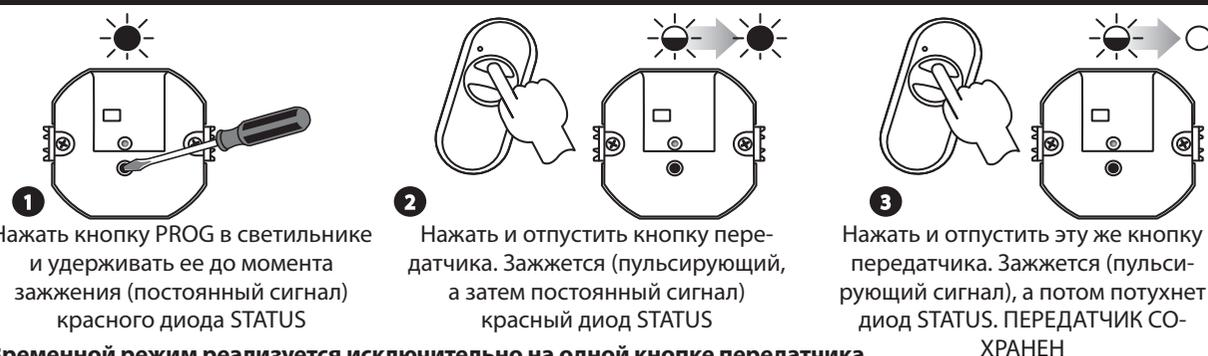
**1** Нажать кнопку PROG в светильнике и удерживать ее до момента зажигания (постоянный сигнал) красного диода STATUS
