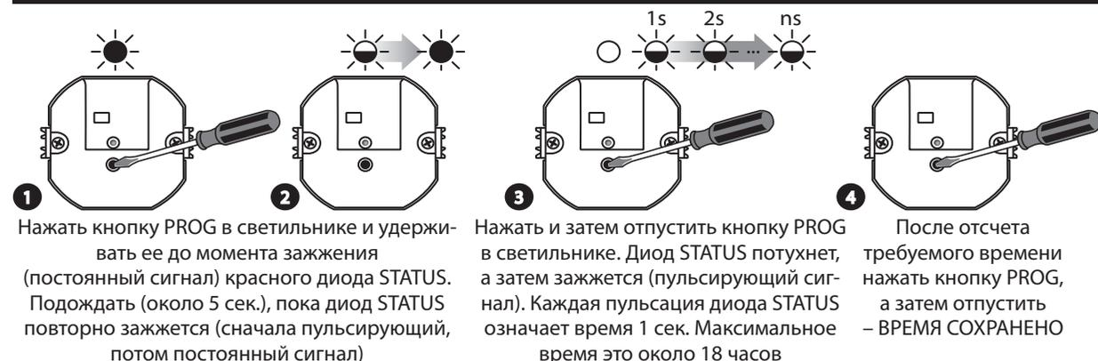
**1** Нажать кнопку PROG в светильнике и удерживать ее до момента зажигания (постоянный сигнал) красного диода STATUS. Подождать (около 5 сек.), пока диод STATUS повторно зажжется (сначала пульсирующий, потом постоянный сигнал)
