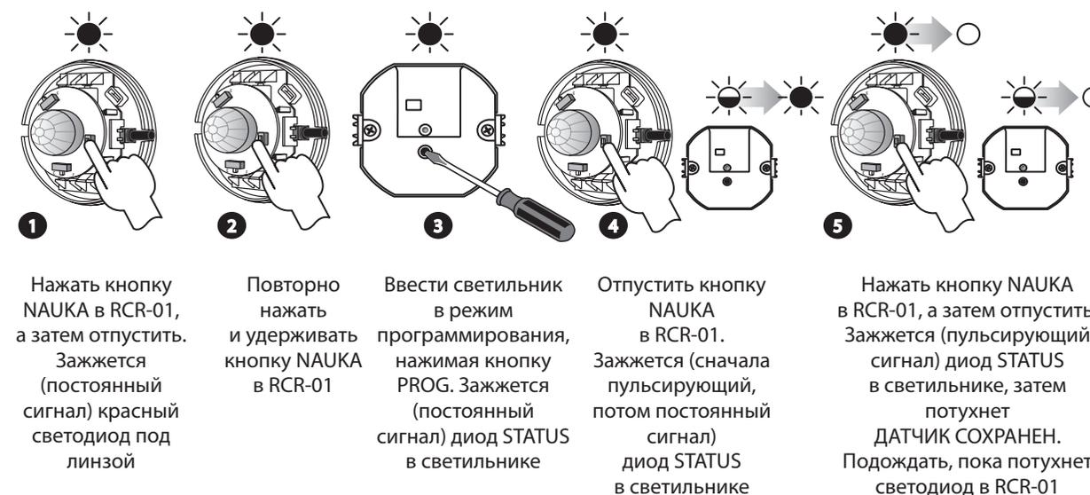
**1** Нажать кнопку NAUKA в RCR-01, а затем отпустить. Зажжется (постоянный сигнал) красный светодиод под линзой
