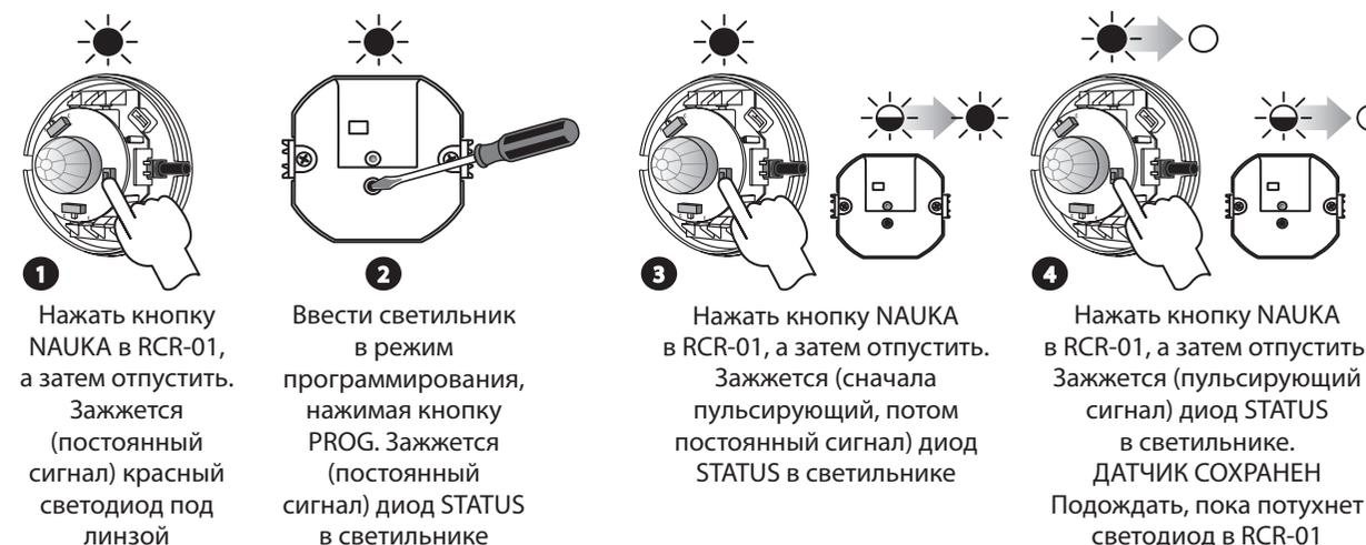
**1** Нажать кнопку NAUKA в RCR-01, а затем отпустить. Зажжется (постоянный сигнал) красный светодиод под линзой
