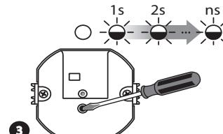
**2** Нажать и затем отпустить кнопку PROG в светильнике. Диод STATUS потухнет, а затем зажжется (пульсирующий сигнал). Каждая пульсация диода STATUS означает время 1 сек. Максимальное время это около 18 часов
