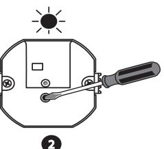
**2** Ввести светильник в режим программирования, нажимая кнопку PROG. Зажжется (пульсирующий сигнал) красный диод STATUS в светильнике
