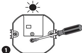
**1** Нажать кнопку PROG в светильнике и удерживать ее до момента зажжения (постоянный сигнал) красного диода STATUS
