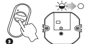
**3** Нажать и отпустить вторую кнопку передатчика (OFF). Зажжется (пульсирующий сигнал), а затем потухнет красный диод STATUS.
