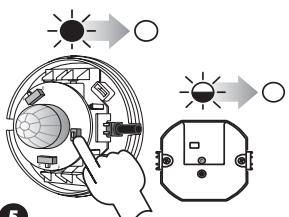
**5** Нажать кнопку NAUKA в RCR-01, а затем отпустить. Зажжется (пульсирующий сигнал) диод STATUS в светильнике, затем потухнет ДАТЧИК СОХРАНЕН. Подождать, пока потухнет светодиод в RCR-01
