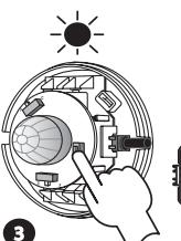
**3** Нажать кнопку NAUKA в RCR-01, а затем отпустить. Зажжется (сначала пульсирующий, потом постоянный сигнал) диод STATUS в светильнике
