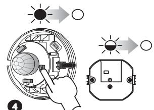
**4** Нажать кнопку NAUKA в RCR-01, а затем отпустить. Зажжется (пульсирующий сигнал) диод STATUS в светильнике. ДАТЧИК СОХРАНЕН Подождать, пока потухнет светодиод в RCR-01
