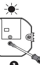
**3** Ввести светильник в режим программирования, нажимая кнопку PROG. Зажжется (постоянnyй сигнал) красный диод STATUS в светильнике
