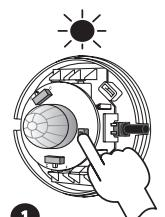
**1** Нажать кнопку NAUKA в RCR-01, а затем отпустить. Зажжется (постоянnyй сигнал) красный светодиод под линзой
