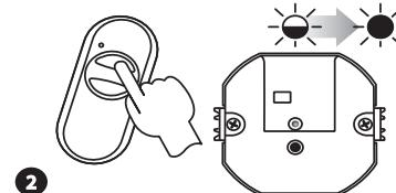
**2** Нажать и отпустить первую кнопку передатчика (ON). Зажжется (сначала пульсирующий, потом постоянный сигнал) красный диод STATUS
