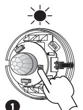
**1** Нажать кнопку NAUKA в RCR-01, а затем отпустить. Зажжется (постоянnyй сигнал) красный светодиод под линзой
