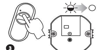
**3** Нажать и отпустить эту же кнопку передатчика. Зажжется (пульсирующий сигнал), а потом потухнет диод STATUS.
