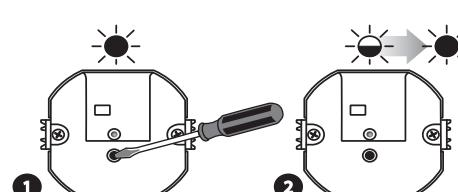
**1** Нажать кнопку PROG в светильнике и удерживать ее до момента зажжения (постоянный сигнал) красного диода STATUS. Подождать (около 5 сек.), пока диод STATUS повторно зажжется (сначала пульсирующий, потом постоянный сигнал)
