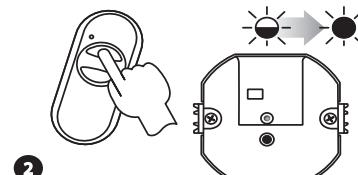
**2** Нажать и отпустить кнопку передатчика. Зажжется (пульсирующий, а затем постоянный сигнал) красный диод STATUS
